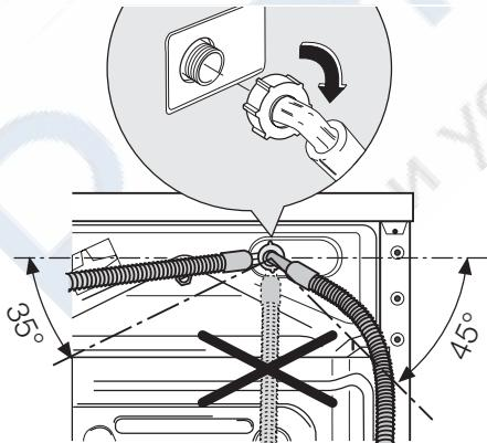
3. Отрегулируйте положение шланга, ослабив зажимную гайку. Отрегули-
