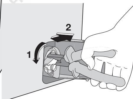
7. Проворачивая крыльчатку насоса, извлеките из него все посторонние предметы.
