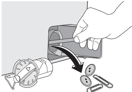
8. Установите фильтр на место, следя, чтобы он как следует встал на место. Затем плотно затяните его.
