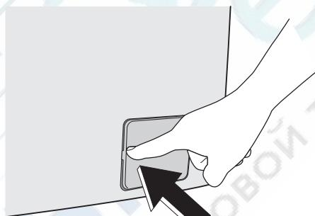
**ВНИМАНИЕ!** При работающем приборе в зависимости от выбранной программы в сливном насосе может быть горячая вода. Никогда не снимайте крышку фильтра сливного насоса во время стирки, всегда дожидайтесь, чтобы прибор завершил цикл и слил воду. При установке крышки на место убедитесь, что она плотно затянута во избежание утечек и возможности снятия ее детьми.
