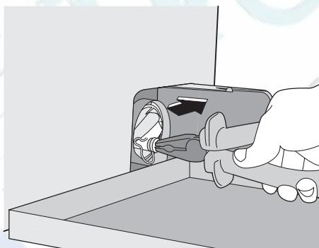
6. Когда вода перестанет литься, отвинтите крышку фильтра и плоскогубцами извлеките фильтр. Всегда держите под рукой тряпку, чтобы вытереть воду, которая может пролиться при снятии фильтра.
