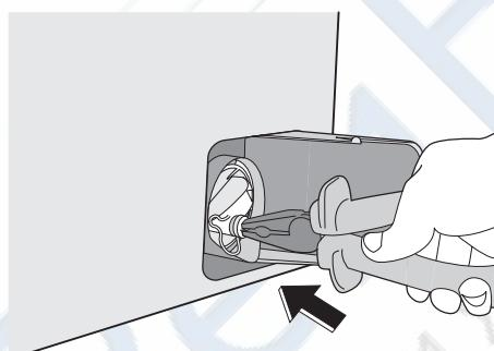
9. Установите на место заглушку отверстия аварийного слива и плотно закрепите ее.
